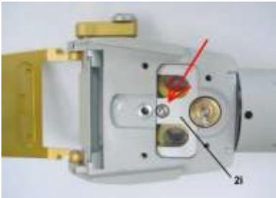
Fig. 3e Removing horn
